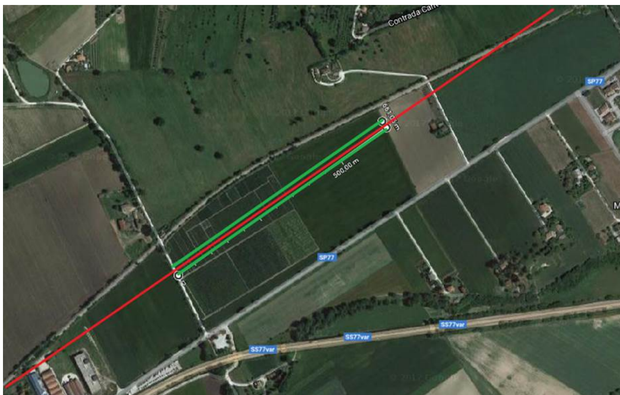
Fig. 2.2/4: Schema direttrice di decollo e atterraggio. Appena fuori dalla pista di decollo gran parte dei velivoli che si possono utilizzare sono oltre 15 m di altezza.
